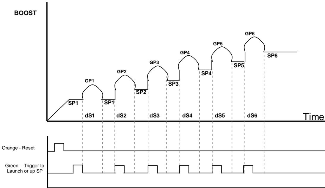
**EXAMPLE 3: COMBINATION OF BOOST SPIKING & BOOST DIPPING BETWEEN BOOST LEVEL SWITCHING**
